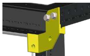
Gornji nosač montažne ploče i montažnog rama
