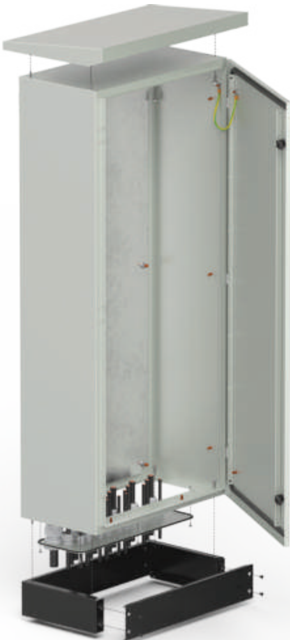
Montaža ormana KB2/8IP65 na demontažno postolje visine 100 mm. Kišni krov ormana je sa prepustom na četiri strane sa nagibom ka leđima.
